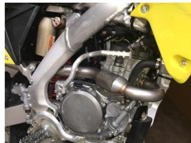
ALL SILENCERS AND HEADERS ARE A SLIP-ON FIT AND DO NOT REQUIRE A GASKET, APART FROM DRZ SILENCERS
